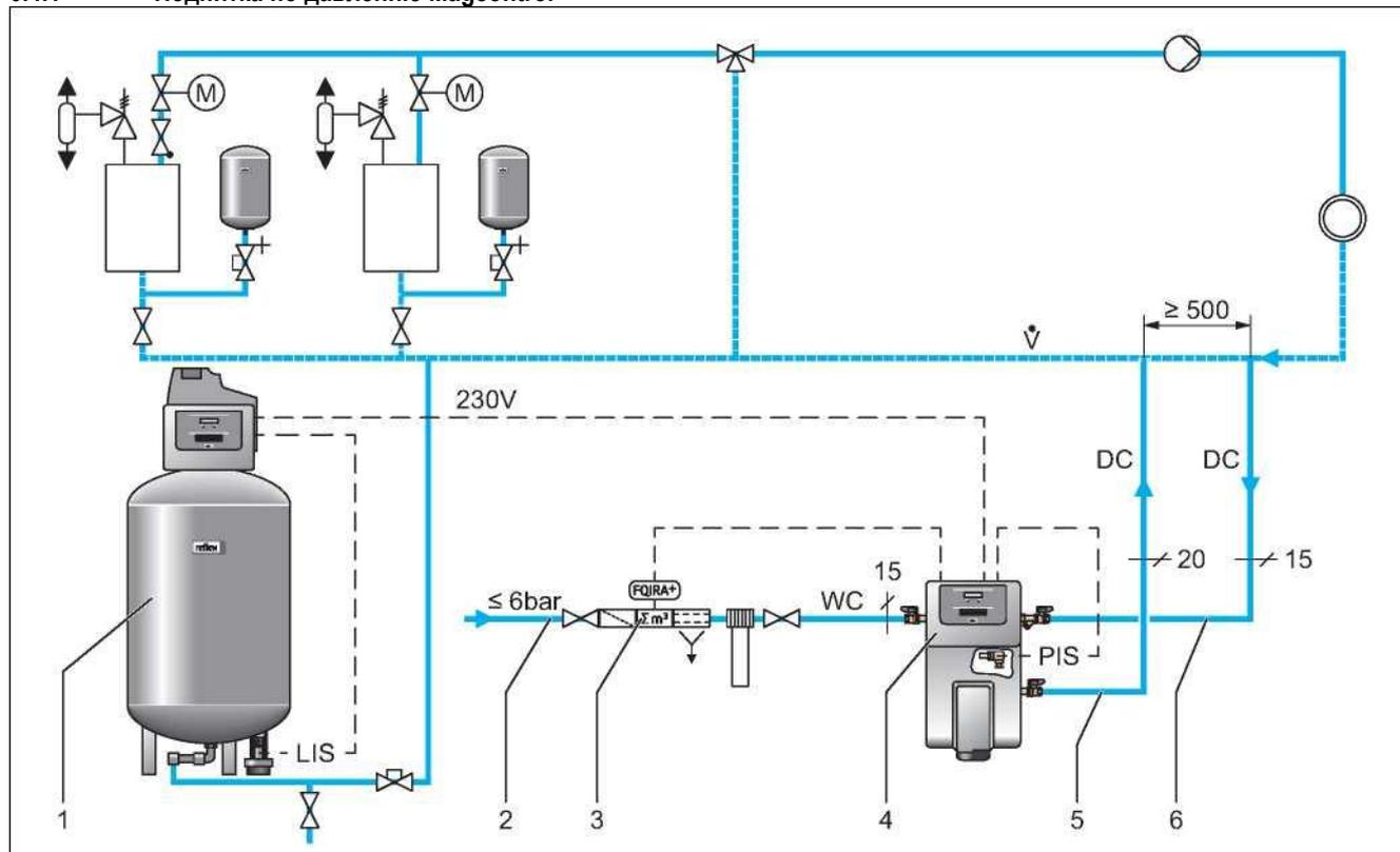
устройство. Подключение деаэрационных линий «DC» вблизи «MAG» позволяет точно контролировать давление для подпитки
