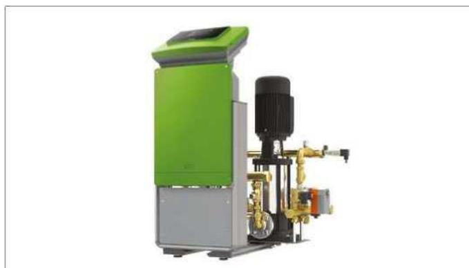
4 Когда заданное давление заполнения будет достигнуто, установка Variomat VZ переходит в режим поддержания давления и включает режим интенсивной дегазации. Блок управления переключит 3-х ходовой регулирующий клапан в положение: линия заполнения - закрыта, линия основной ёмкости - открыта.
